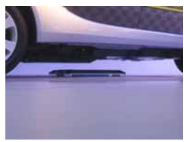
三菱自動車 iMiEV用磁界共鳴式(Gap100mm、水平方向位置ずれ±200mmで85%の出力)
