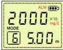
汚泥濃度測定表示
