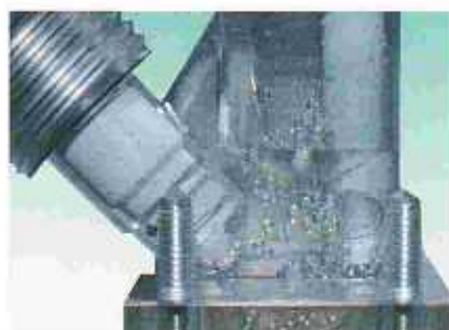
ビーズ噴流洗浄機能付小流量オーバーフロー型フローセル
